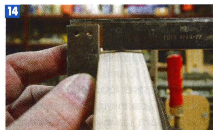
14 Колесо обточил до нужного диаметра, придав кромке бочкообразную форму. Скос в каждую сторону — примерно 5 градусов.
