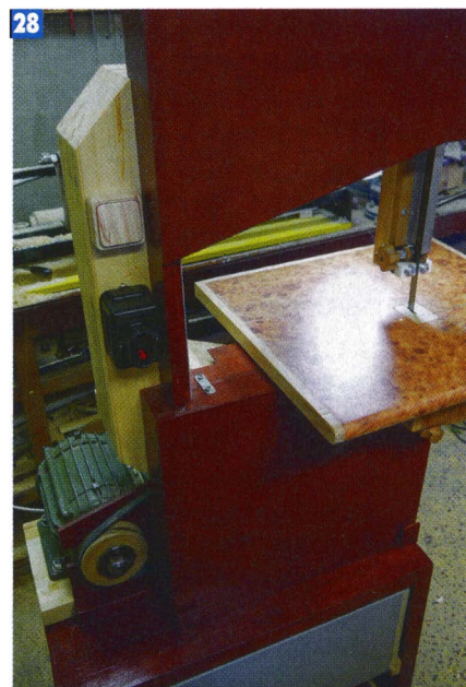
Так выглядит защита подвижных элементов. Установлены пусковая кнопка пилы и выключатель подсветки.
