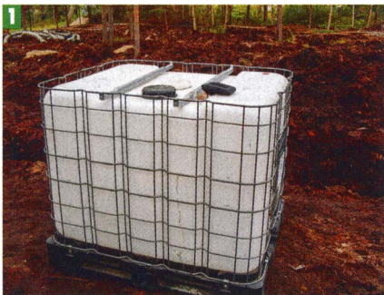
1 Для постройки септиков я приобрел еврокубы объёмом 600 и 1 000 л.
