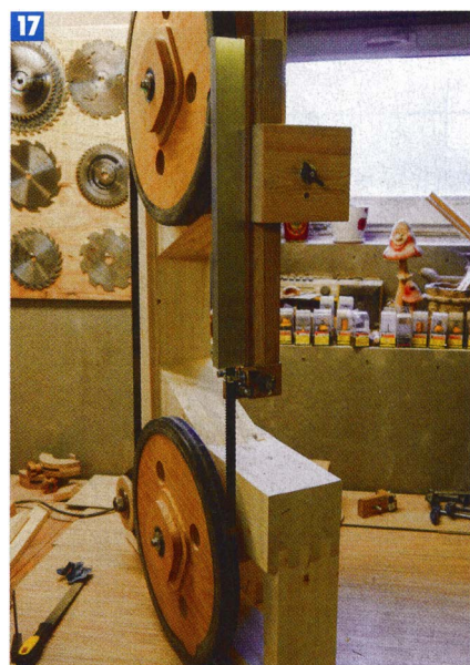
17 Установлена направляющая с верхним опорным подшипником, но пока без «сухарей». На колёса натянуты резиновые камеры (после окончательной сборки их нужно приклеить).
