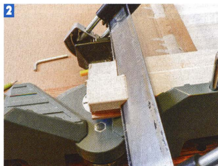
2 Без струбцины отпилить брус под нужным углом было бы трудно.
