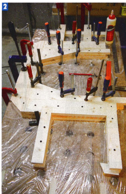
2 При приклеивании следующих слоёв нехватка струбцин компенсируется саморезами.
