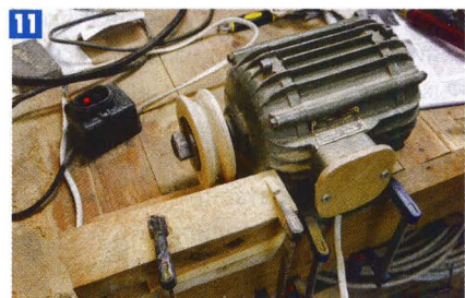
11 Шкив двигателя точил непосредственно на самом двигателе.
