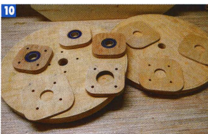
10 Фланцы (часть — с подшипниками) с подкладками подогнаны к заготовкам колес и промаркированы.
