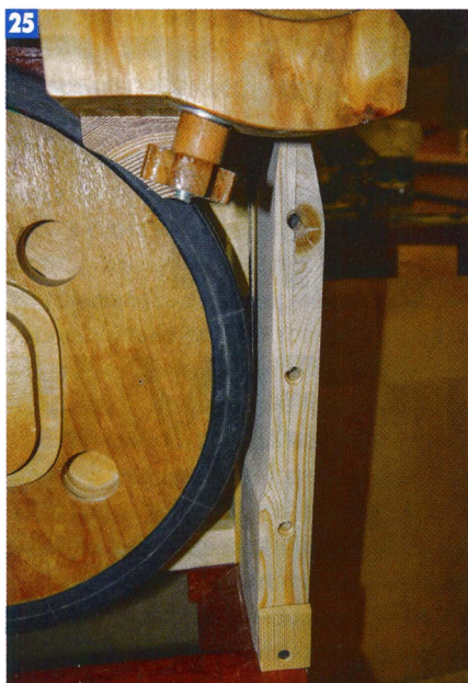
Правая стенка кожуха нижнего колеса скошена сверху для упрощения замены пильных полотен.
