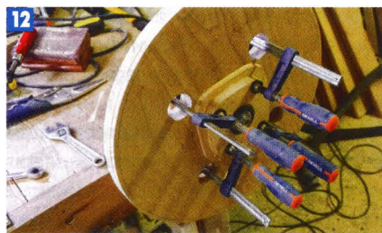
12 Когда все детали были готовы, приклеил фланцы к колесу.
