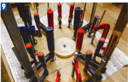
9 Склеивание колеса из трёх фанерных кругов.
