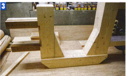
3 К готовой раме прикручены направляющие для подвижного блока верхнего колеса.
