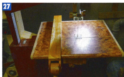
Параллельный упор закреплён на рабочем столе.
