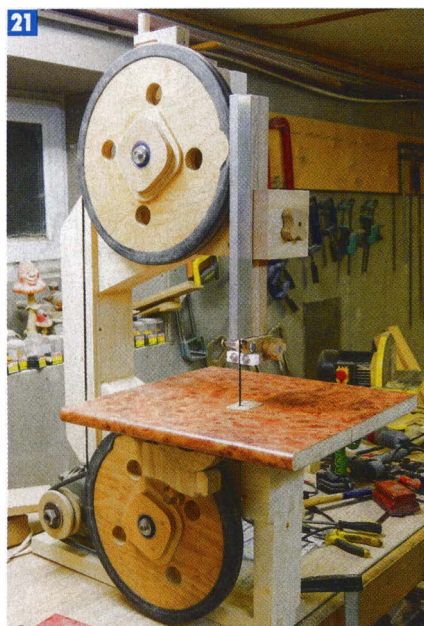
21 Установлены рабочий стол с пластиной нулевого зазора и вороток механизма натяжения пилы. Станок готов к испытаниям.
