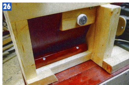
Задняя стенка защиты нижнего колеса установлена наклонно и направляет опилки в ящик.
