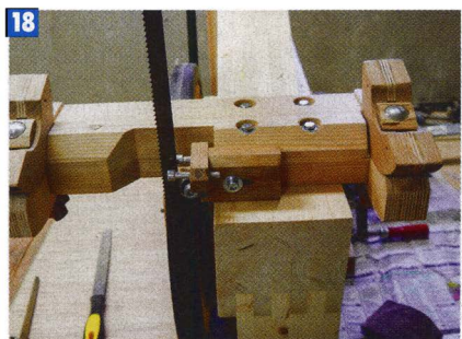
18 Опора рабочего стола оснащена механизмом наклона.
